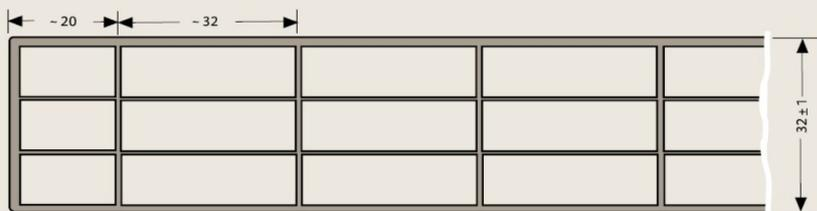
Querschnitt der PLEXIGLAS® Resist S4P 32 (Maße in mm)
