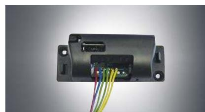
**Funkempfängermodul im Gehäuse (2-Kanal)**
